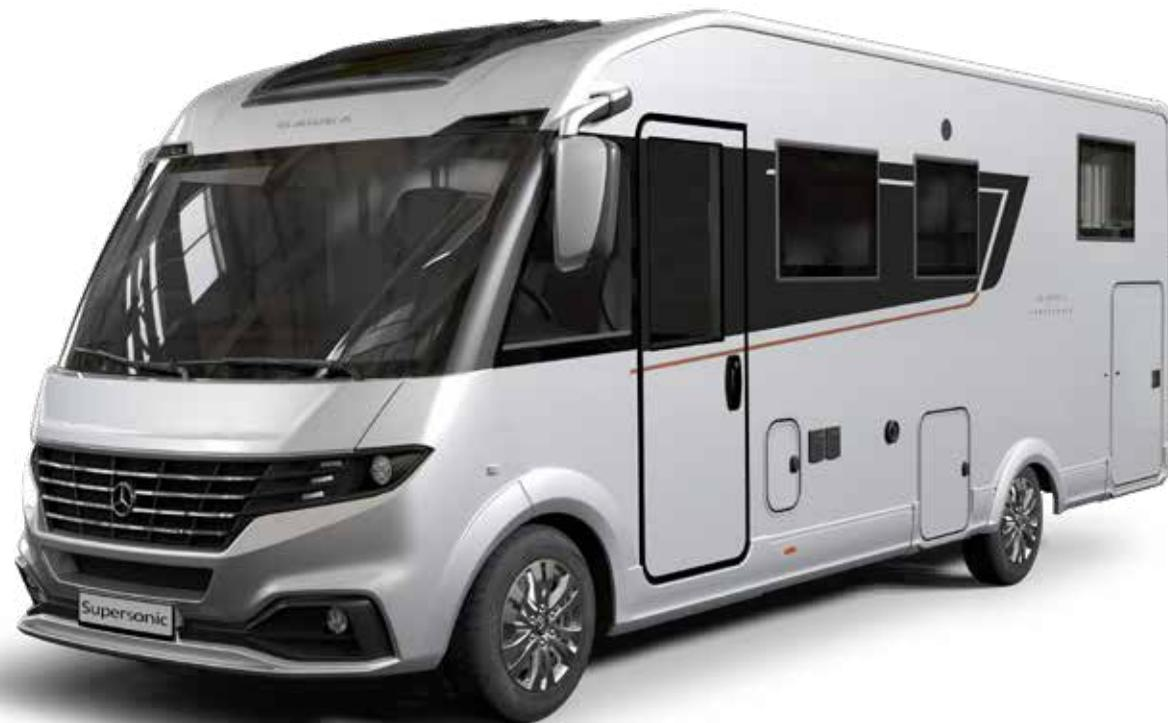
*Exklusiver Frontgrill mit HELLA Tagfahrlicht und Bi-LED-Modulen, integriertem Stoßfänger und LED-Nebelscheinwerfern sowie statischem Abbiegelicht.*
