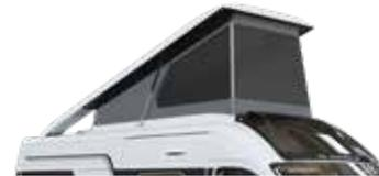
Bei den längeren 640er-Modellen sorgt ein technisch hochentwickelter, einfach zu bedienender Schwenköffnungs-Dachmechanismus mit verlängerten Seitenarmen für ein perfektes Schließen und die Integration in das Dach, wenn es nicht genutzt wird, sowie für Stabilität gegen Wind, wenn es genutzt wird.
