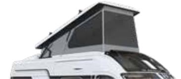
Bei dem kürzeren 540er und 600er Modell verfügt das kompakte Aufstelldach über einen einfach zu bedienenden Scherenmechanismus, der ebenfalls ein perfektes Schließen ermöglicht. Beide Varianten verfügen über zwei separate Dachverriegelungsmechanismen.
